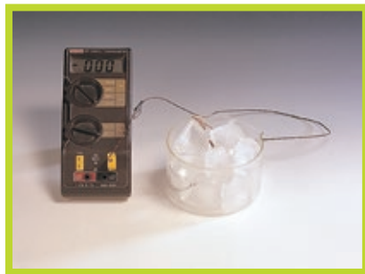
En el recipiente de vidrio se coloca hielo y agua líquida. El termómetro marca 0 °C.
