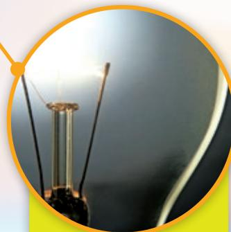
Las lamparitas incandescentes, hoy en desuso, tienen en su interior un filamento de metal que se calienta mucho y emite luz cuando lo atraviesa una corriente eléctrica.
