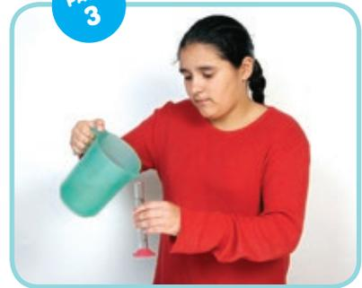
Para medir el volumen de la bolita, viertan agua en la probeta hasta un determinado nivel y regístralo (en la lectura, el nivel debe quedar a la altura de los ojos).
