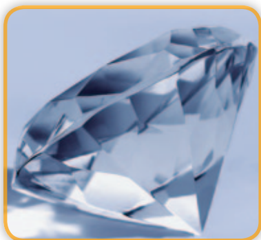
El diamante es muy duro. La dureza es la resistencia de un material a ser rayado.
