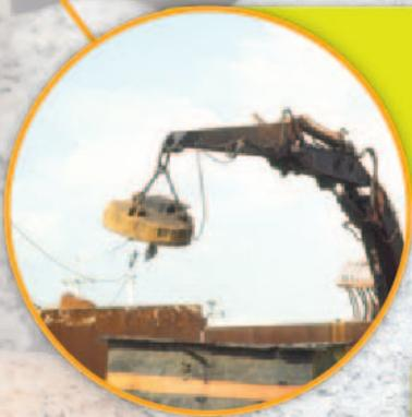
Los imanes atraen al hierro y al níquel; se los puede usar para separar ciertos materiales que contienen hierro de otros que no. La separación magnética se usa para separar residuos.
