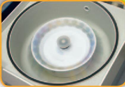
Es un proceso de sedimentación acelerado. Se usa para separar suspensiones de materiales de diferentes densidades, ya sea un sólido y un líquido o dos líquidos. Por ejemplo, para separar el suero de la sangre.
