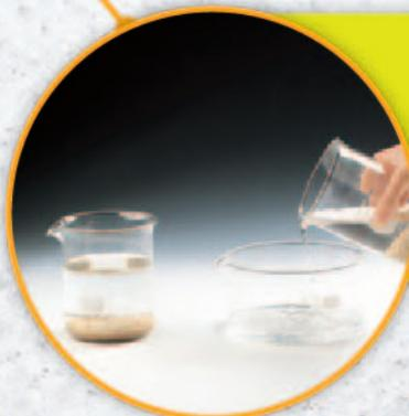
Si se deja un vaso con agua de río en descanso un buen rato, la arcilla se depositará en el fondo. Se dice que el sólido **decantó** o **sedimentó**, así el líquido se puede pasar a otro recipiente. La decantación se usa en el proceso de depuración del agua para consumo.
