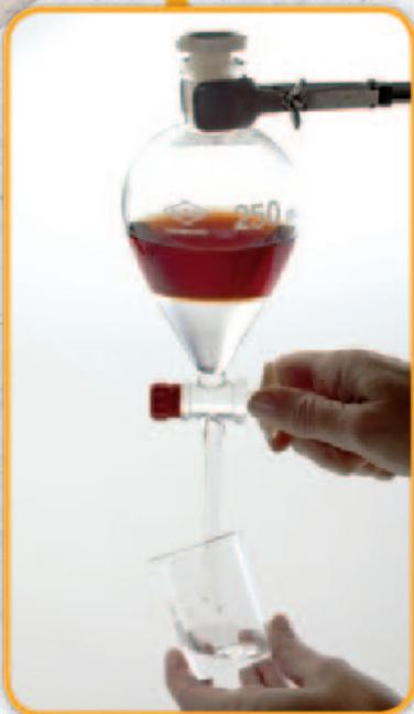
Para separar dos líquidos que no se mezclan, como agua y aceite, se usa una ampolla de decantación. El aceite flota sobre el agua y se forman dos capas. La ampolla tiene una llave y, al abrirla, sale el agua que está en la parte inferior. Luego, se cierra la llave y el aceite queda en la ampolla.
