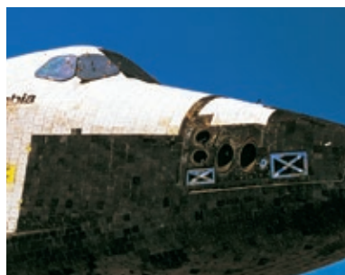
Los transbordadores están recubiertos de losas cerámicas resistentes a altas temperaturas.
